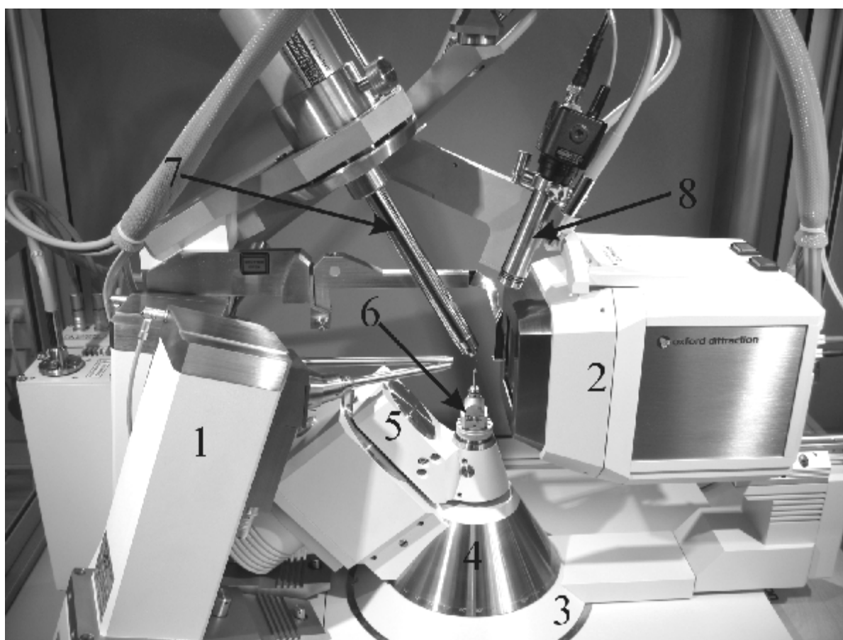
Рис. 8.13. Дифрактометр с каппа-гониометром и координатным CCD детектором Gemini-S (лаборатория рентгеноструктурных исследования ННГУ).
