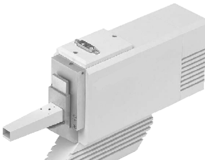
Рис.7.12. Точечный детектор для монокристалльных исследований (Oxford Diffraction)
